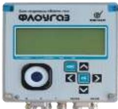
1.1 Блок коррекции объема газа «Флоугаз» (далее блок) предназначен для приведения рабочего объема природного газа по ГОСТ 5542-2014, свободного нефтяного газа по ГОСТ Р 8.615-2005, других газов, проходящих через счетчик газа, к стандартным условиям в зависимости от значений давления, температуры и вычисленного коэффициента сжимаемости газа.
